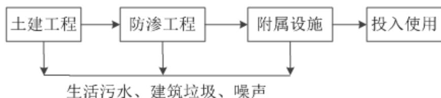
图 2-1 施工期工艺流程图
